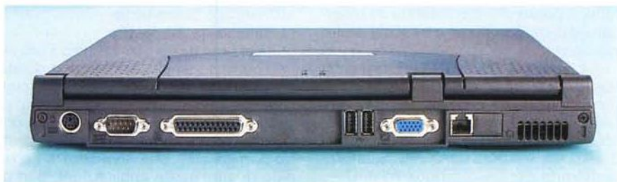
Le capacità di espansione del TravelMate 210TER si concretizzano in porte e connettori concentrati quasi esclusivamente sul lato posteriore del portatile: sono qui visibili, privi di sportelli di protezione, il connettore PS/2 per mouse o tastiera esterni, le porte seriale e parallela, una doppia interfaccia USB, il connettore SVGA a 15 pin e quello RJ11 del modem integrato.
